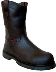
ROPER 600 MONARCA (PETROLERA) TIPO DE CALZADO: DIELECTRICO + PROTECCIÓN A LA PUNTA COLOR: CAFÉ NUMERACIÓN: 24 AL 30 PLANTILLA: EVA ALTA DENSIDAD SUELA: PVC ELASTOMERO (PEMEX) PUNTERA DE PROTECCIÓN: POLIAMIDA FABRICACIÓN: LOCKSTITCHER FORRO INTERIOR CORTE: PIEL GRASSO HORMA: EEE
