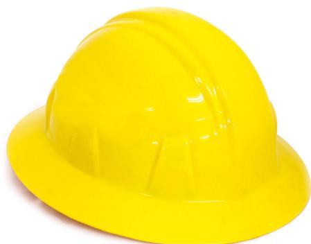
Casco de seguridad de ala completa consisten en una estructura de polietileno (concha) y un sistema de suspensión que juntos crean un sistema de protección. Cumplen los requisitos aplicables para un casco Tipo I (impacto superior), establecidos por la normatividad mexicana. Diseñados para proveer protección contra impactos (limitada) y penetración a la cabeza de los usuarios, así como a la tensión eléctrica.
