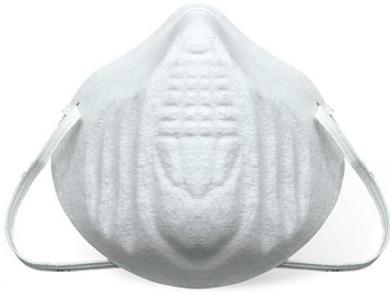
CONFIABLE EN USO PARA PARTICULAS NO TOXICAS CON NIVEL DE EXPOSICION POR DEBAJO DE 15mgm3 Y POLVOS DE 12 MICRONES EN ADELANTE, APLICACIONES EN ALMIDON, ALUMNA, ALFALFA, BAUXITA, BENTONITA, CARBONATO DE CALCIO, CAOLIN, CAUCHO, DIOXIDO DE TITANIO ESMERIL, ESTRATO DE ZINC, GRAFITO, MAGNESIA, MARMOL, POLVO DE VIDRIO, SAL, SILICIO, SACAROSA YESO.
