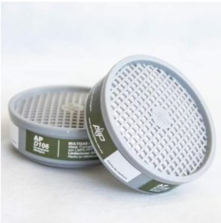
Es un cartucho diseñado para protección respiratoria en atmosferas conteniendo una concentración no mayor a 1000 ppm de Vapores Orgánicos, altamente microporoso para oxidar compuestos organicos cuya volatilidad no los hace adsorbibles para un carbón estándar, entre estos están los Aldehidos, Alcoholes, Alquenos y Alquinos.
