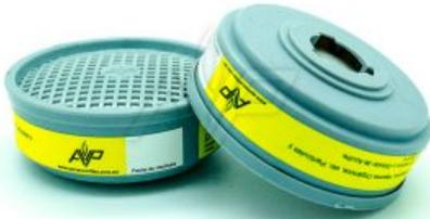
Es un cartucho diseñado para protección respiratoria en atmosferas conteniendo una concentración no mayor a 1000 ppm de Vapores Orgánicos, 10 ppm de cloro, 50 ppm de Acido Clorhídrico, 50 ppm de dióxido de Azufre.
