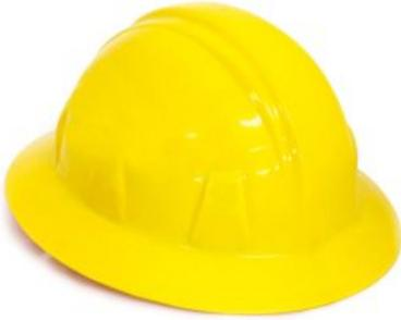
Casco de seguridad de ala completa consisten en una estructura de polietileno (concha) y un sistema de suspensión que juntos crean un sistema de protección. Cumplen los requisitos aplicables para un casco Tipo I (impacto superior), establecidos por la normatividad mexicana. Diseñados para proveer protección contra impactos (limitada) y penetración a la cabeza de los usuarios, así como a la tensión eléctrica.
